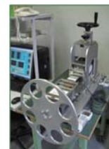
応力印加機能付単板磁気特性試験器
