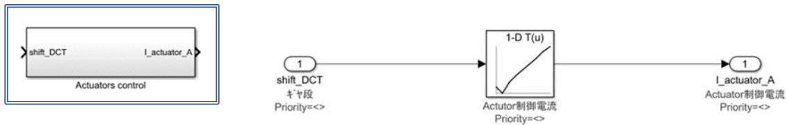
図 3.4.4.2. 電動アクチュエータ制御モデルダイアグラム
