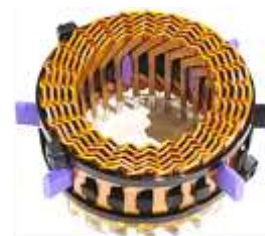
分布巻アルミニウム巻線の試作機
