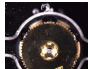
5万rpm超ギヤでは潤滑油供給困難
